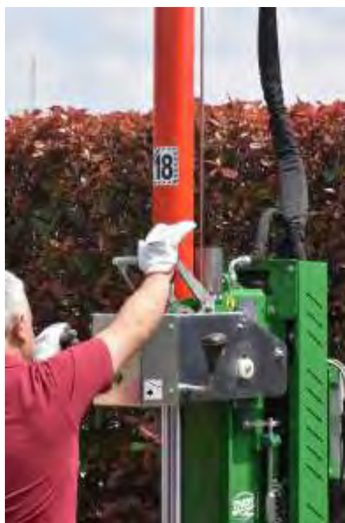
Houtkliefmachine MAGIC EVOLUTION met LEADER EVOLUTION systeem 13, 18 of 20 ton.
