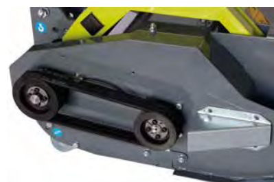
3 V-snaren Beveiliging V-snaardeksel
